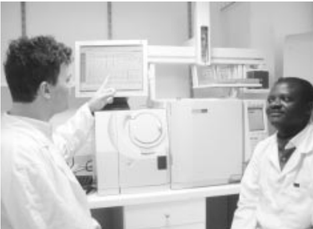
Figure 5 - Identification chromatographique de l'artémisinine
